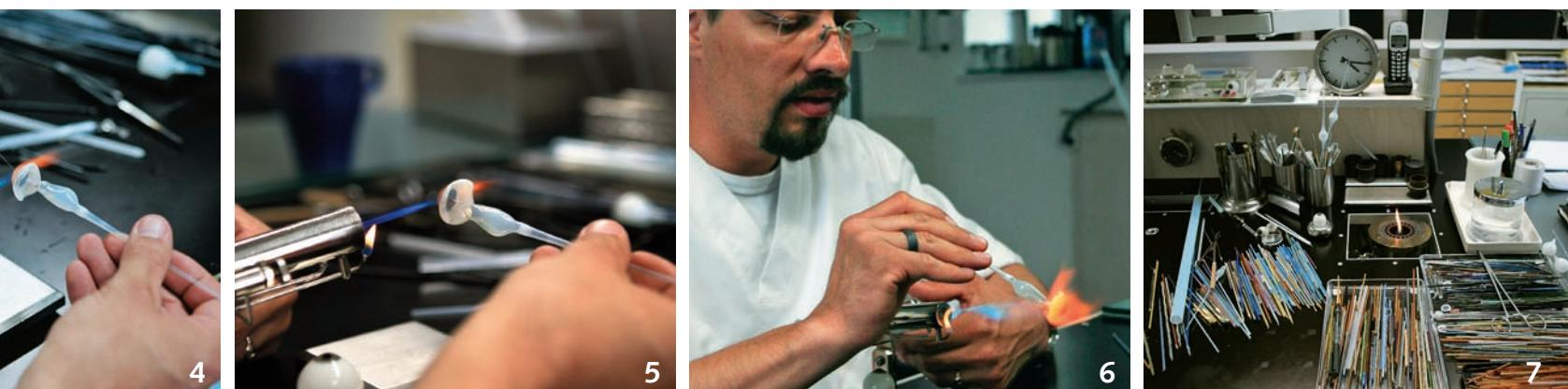
etwas Luft hinein. Manchmal erhitzt er nur die Spitze des Rohlings wendet und dreht ihn so lange, bis eine warzenartige Ausbuchtung entsteht, die er dann bearbeitet. Wenige Arbeitsschritte später ist alles wieder eine kleine Kugel. Was man denn als Voraussetzung mitbringen müsse für diesen Beruf? „Geduld und eine hohe Frustrationstoleranz“ ist seine spontane Antwort.
