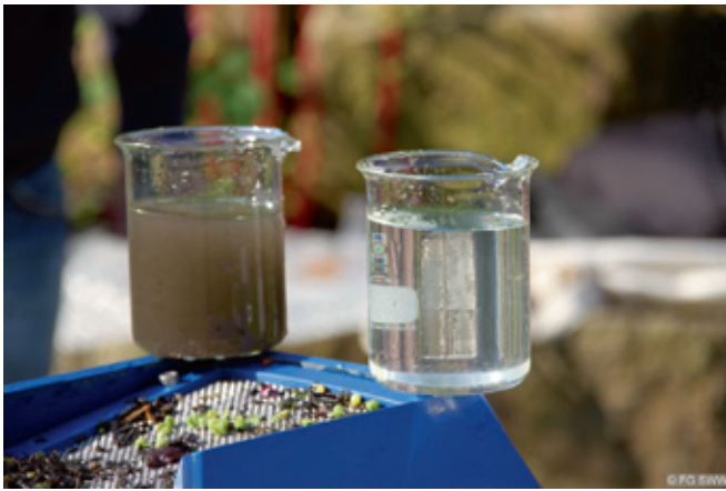
Augenfälliger Beweis für einen funktionierenden Filter: Die Wassertrübung verschwindet vollständig.
