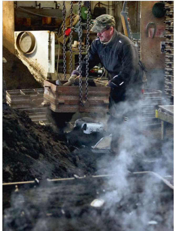
Nach dem Guss entfernt Peter Herzog den Sand aus dem Formkasten.
