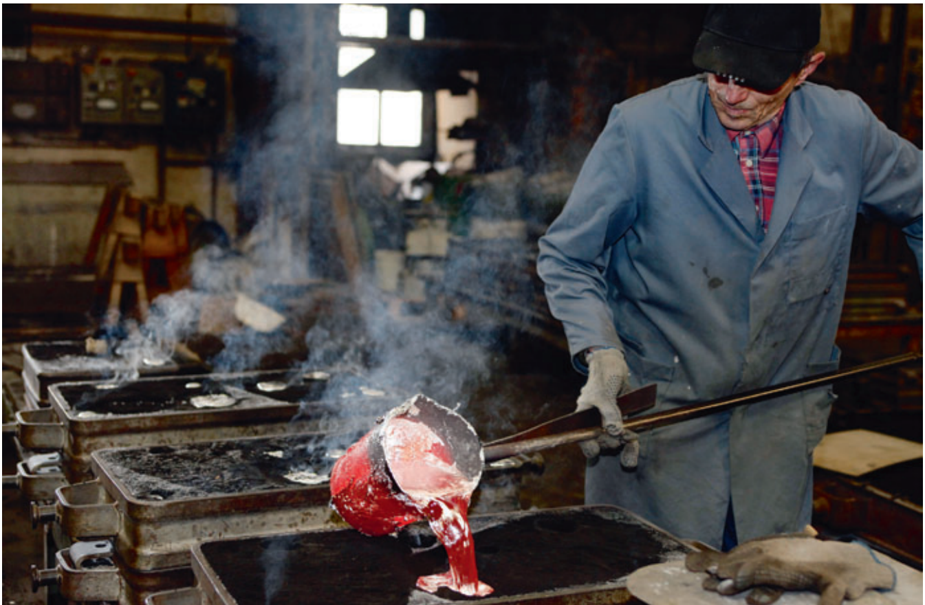
Mit einem Gusslöffel wird das geschmolzene Aluminium in die Form gegeben.
